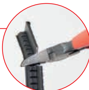
Parhaiten katkaisu onnistuu sivuleikkureilla
